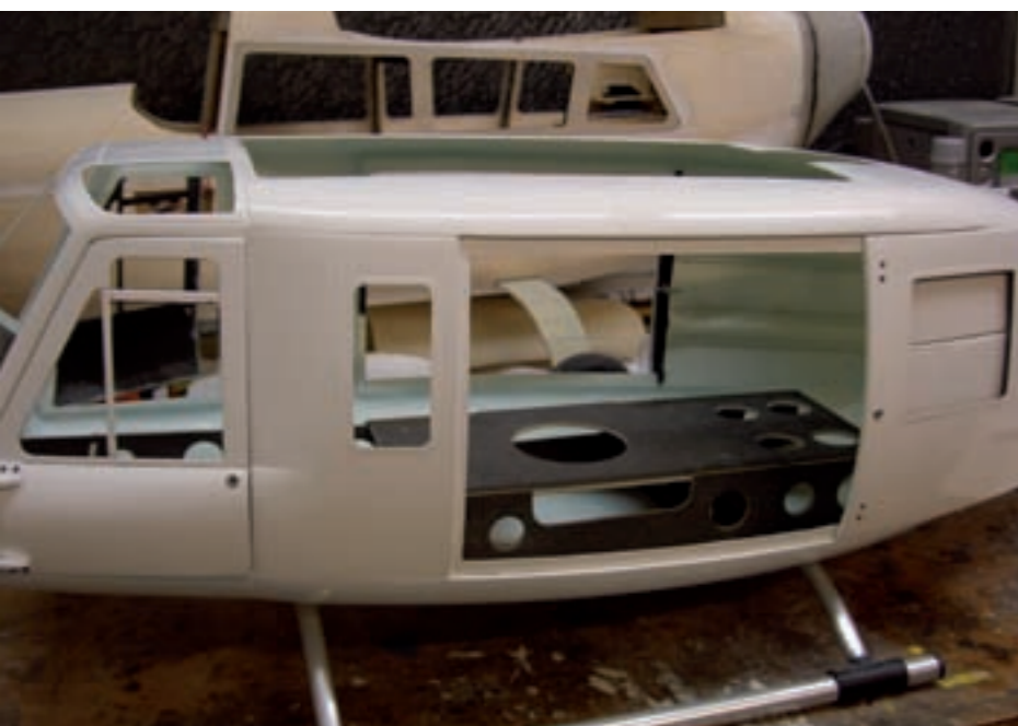
Der Spantensatz besteht aus Kohle-Balsa-Laminat
