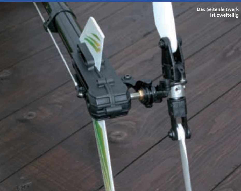
Die etwas andere Haubenbefestigung. Der rechte Stift muss noch reingedrückt werden, damit der Verschluss sicher hält
