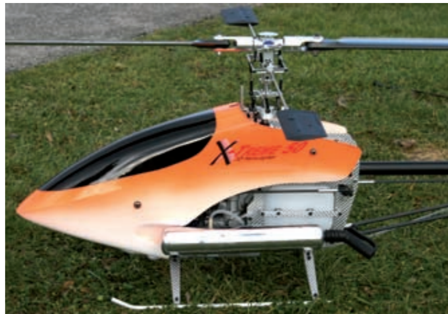
Der neue Dämpfer aus dem Hause R/JX Hobby: Mittels eines Gummideckels kann der Dämpfer verschlossen werden, sodass beim Transport nichts ausläuft
