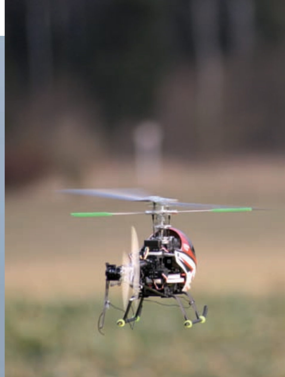
Die grünen, leichten Paddel und CFK-Hauptrotorblätter machen den Heli extrem agil
