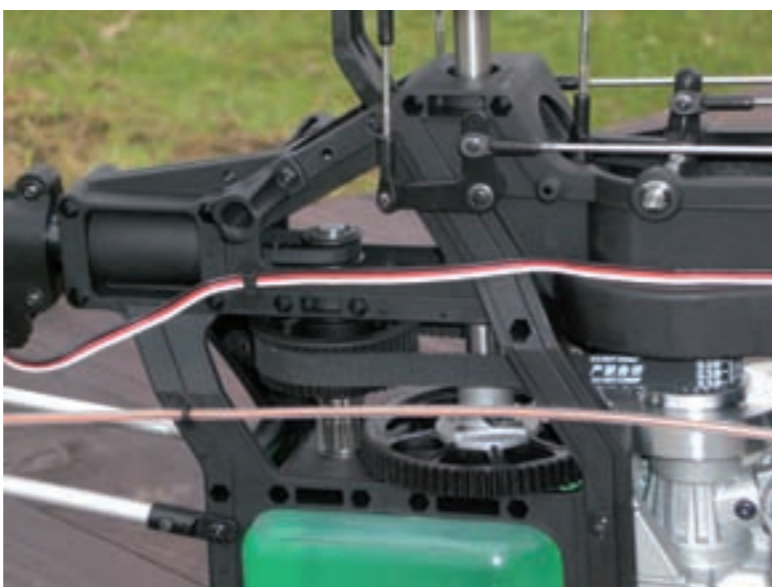
Zweistufige Getriebeeinheit und Umlenkhebel zur Taumelscheibe
