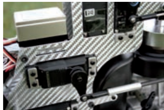
Hier ist der Kühlluftschacht zu erkennen, der etwas tiefer über die Kühlrippen des Motors gezogen werden sollte. Temperaturprobleme gab es bei den Testflügen jedoch nicht. Auf der rechten Seite ist der Spannungs-limiter montiert
