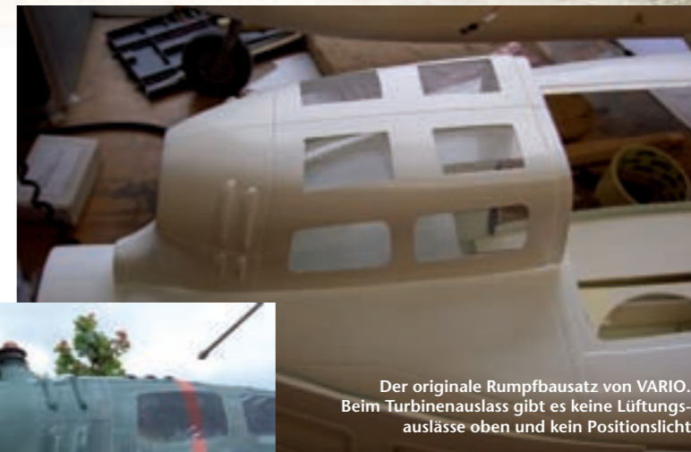
Im Bild ist der modifizierte Turbinenauslass zu sehen, der nun die Lüftungsgitter und das Positionslicht enthält
