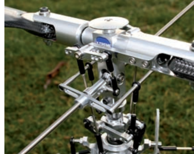
Der Rotorkopf hat imposante 108 verschiedene Setup-Möglichkeiten. Durch das anodisierte Aluminium ist die Optik einfach klasse
