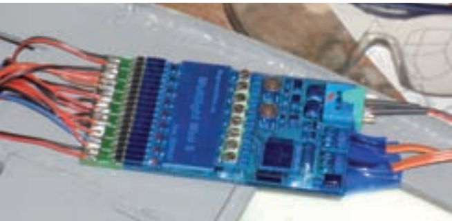
Die Multilight-Mini-Elektronik steuert die gesamte Beleuchtung über neun Kanäle
