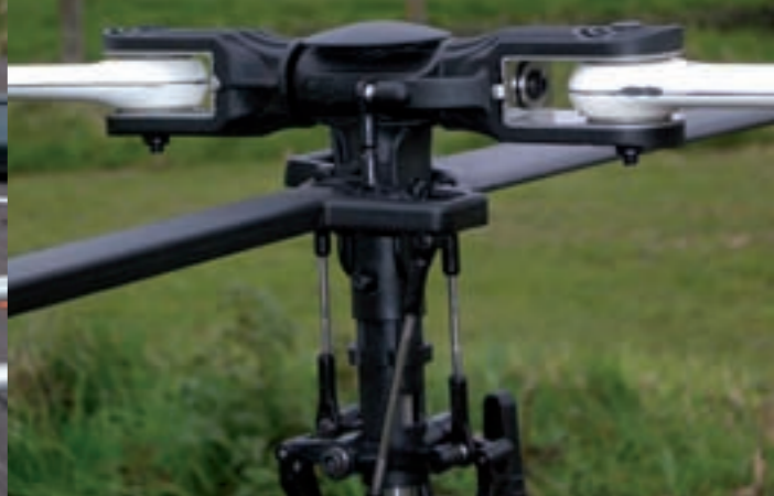
Hauptrotorkopf mit integrierter Rotorkopfbremse und Metalleinlagen im Blatthalter
