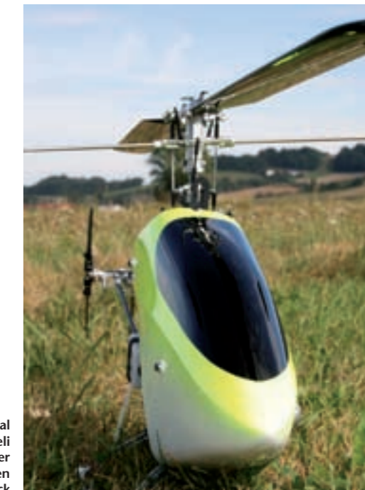
Der Rotorkopf hat imposante 108 verschiedene Setup-Möglichkeiten. Durch das anodisierte Aluminium ist die Optik einfach klasse
