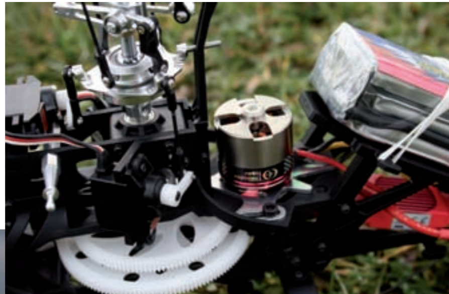
Hier ist der Brushlessmotor OBL 29/37-10H (OP) zu sehen, der dem Heli die notwendige Power gibt. Am neuen Regler sind nun Kühlrippen, sodass er auch unter starker Last nicht heiß wird
