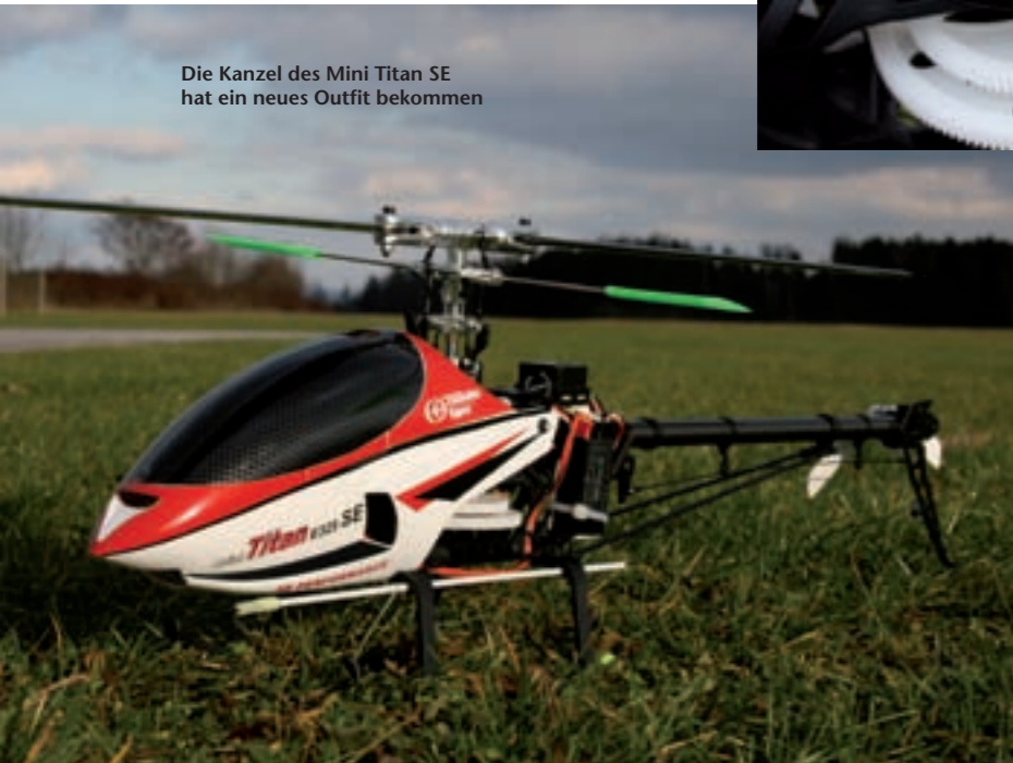
Das Heck des Mini Titan SE besteht zum großen Teil aus Alu und ist sehr leichtgängig. Da Alu vermutlich zu schwer wäre, ist das Heckrotorgehäuse aus Kunststoff
