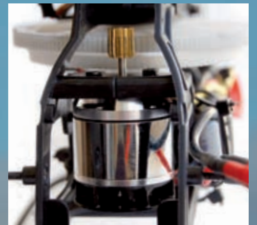
Der Brushlessmotor ist bereits ab Werk montiert und mit einem effizienten Kühlgebläse versehen. Das serienmäßig aufgepresste Ritzel hat 13 Zähne
