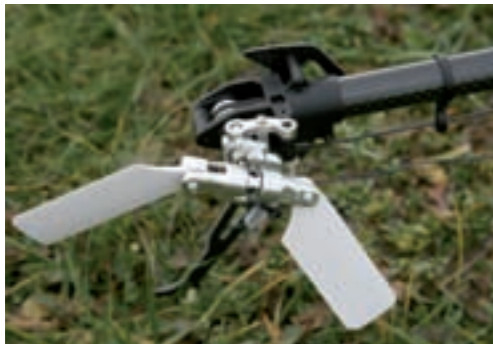
Das Heck des Mini Titan SE besteht zum großen Teil aus Alu und ist sehr leichtgängig. Da Alu vermutlich zu schwer wäre, ist das Heckrotorgehäuse aus Kunststoff
