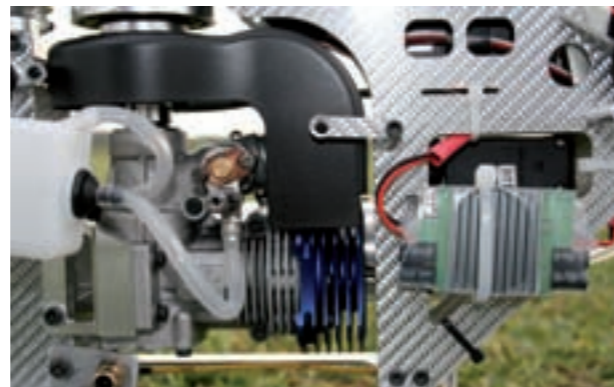
Hier ist der Kühlluftschacht zu erkennen, der etwas tiefer über die Kühlrippen des Motors gezogen werden sollte. Temperaturprobleme gab es bei den Testflügen jedoch nicht. Auf der rechten Seite ist der Spannungs-limiter montiert
