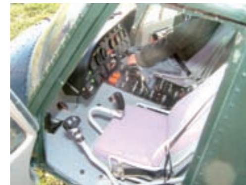
Damit die Sitze zur Optik der Mechanik passen, wurden aus der Standard-Ausrüstung von SSM mit roten Bezügen graue Pendants geschneidert. Außerdem erfolgte eine Anpassung der Sitzform
