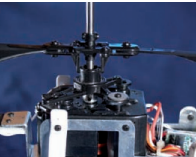
Alles im Lot. Zwei armlose Mikroservos steuern das Ganze zuverlässig
